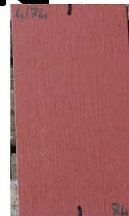
Campione con antifouling a base di Ag (<0.04% wt) e Cu nanostrutturati ClusterNanoTech
