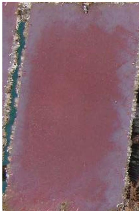
Vernice priva di biocidi e rame su cui è stata depositata e asciugata una soluzione contenente cluster di ioni Ag made in ClusterNanoTech
