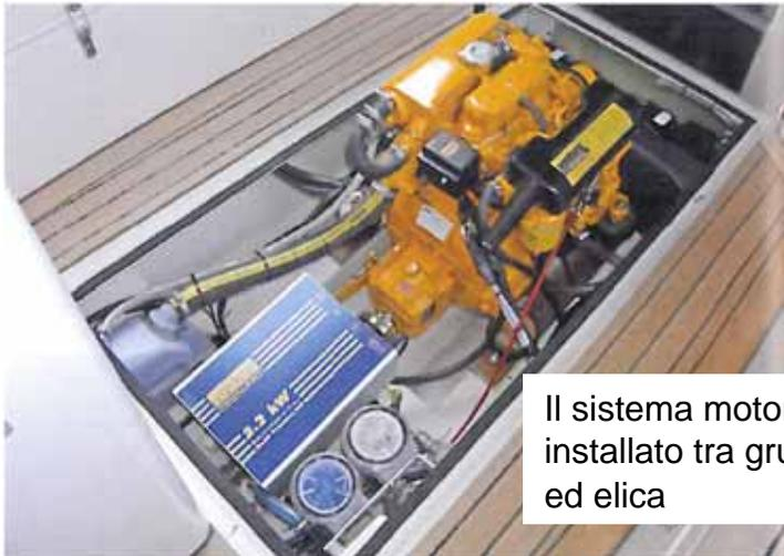
Il sistema motore elettrico **VETUS** installato tra gruppo motore-invertitore ed elica
